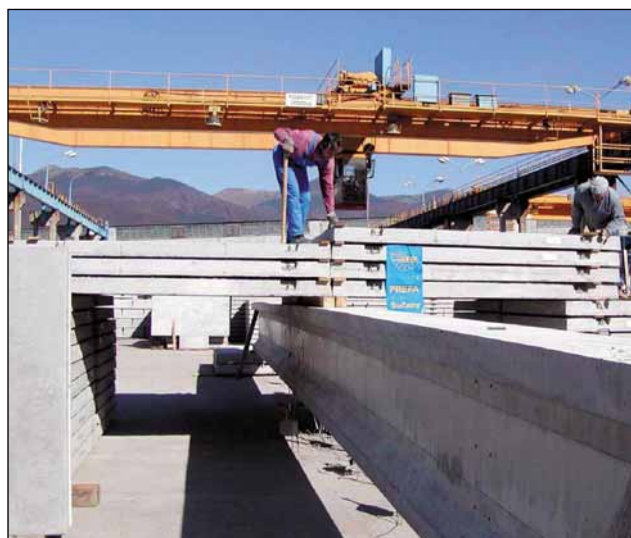
Obr. 5 Postup zaťažovania Fig. 5 The loading scheme of girder
